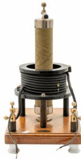
Teslin transformator (elektrika)
